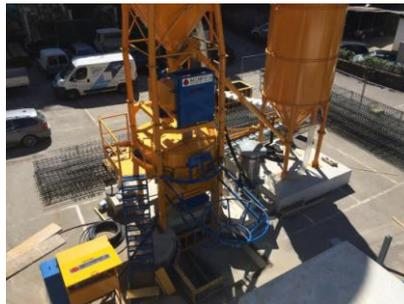
MOBILE : impianti con stoccaggio inerti a tramogge di facile trasporto e montaggio con produzioni dai 25 a 100 mc/h
