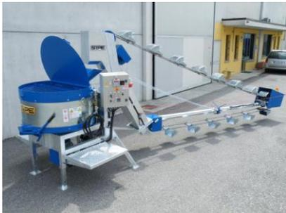
TORRE : Impianti a raggio raschiante automatici ed autonomi , di varie capacità da 350 lt a 1500 , di grande flessibilità di montaggio e con una larga gamma di accessori .
